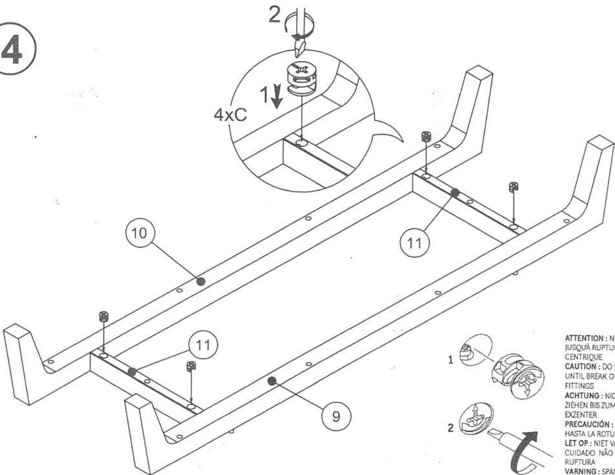
ATTENTION : NE PAS SERRER JUSQU'A RUPTURE DE L'EX-CENTRIQUE
