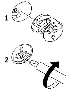
**ATTENTION : NE PAS SERRER JUSQU'À RUPTURE DE L'EX-CENTRIQUE**
