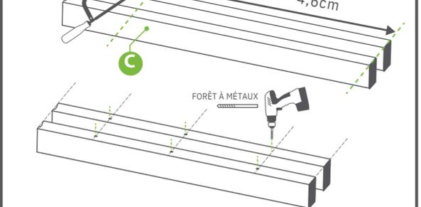
9 Présenter les deux montants à la maçonnerie, tracé les trous de fixation à l'aide d'un crayon. Retirer les montants, percer et insérer les chevilles.
