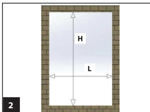
Mesurer la largeur et la hauteur de l'encadrement.
