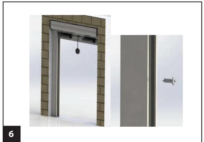
Fixer les profils latéraux dans l'encadrement.
