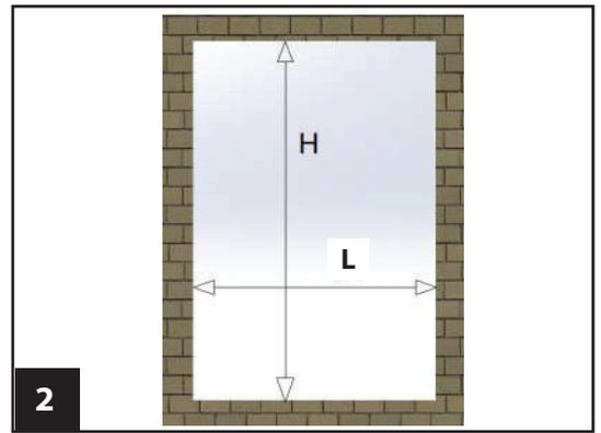
Mesurer la largeur et la hauteur de l'encadrement.
