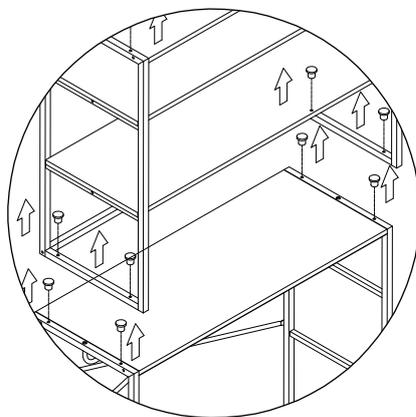
Retirer les caches des 2 modules au niveau de la jonction
