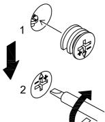
ATTENTION: NE PAS SERRER JUSQU'À RUPTURE DE L'EX-CENTRIQUE
