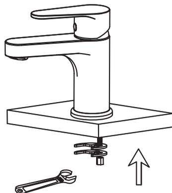
Installez la rondelle en caoutchouc puis la rondelle en métal ainsi que l'écrou de fixation. Serrez à la main puis serrez sans forcer à l'aide d'une clé de serrage.
