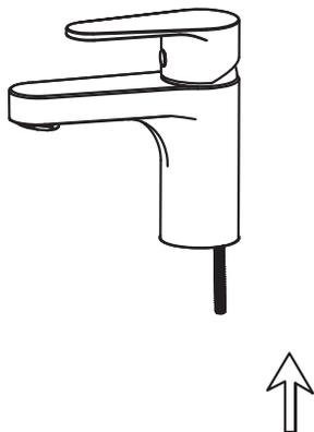
Fixez le goujon fileté en l'insérant dans le trou du corps du robinet et en le serrant aussi fermement que possible à la main.
