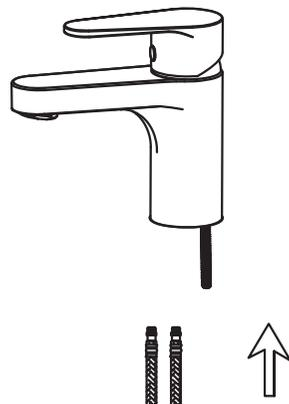
Vissez les flexibles d'entrée chaud et froid dans le corps du robinet. N'utilisez pas de clé pour serrer les flexibles car cela pourrait endommager la taille et/ou le filetage des flexibles.
