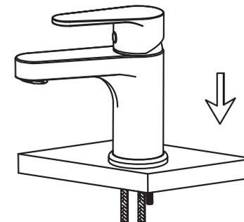
Insérez l'anneau d'embase au robinet puis installez le robinet dans l'orifice de la vasque.
