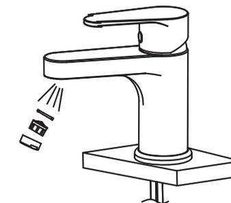
Retirez l'aérateur et laissez couler l'eau pendant environ 1 minute afin d'éliminer toutes les impuretés du robinet. Remettez l'aérateur en place.
