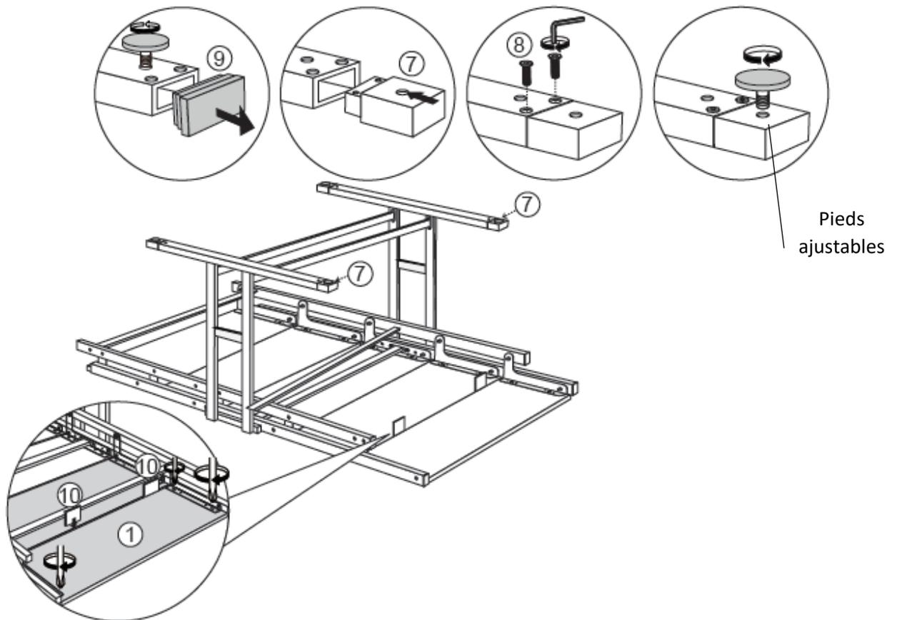
NB : si les planches ne sont pas plates, ou un écart trop important entre les planches, utilisez les cales pcs 10 à insérez entre les panneaux pour régler (voir dessins ci-dessous). Ceci est valable pour l'étape 2 quel que soit l'option choisie (avec ou sans extension de pied).
