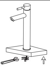
Installez la rondelle en caoutchouc puis la rondelle en métal ainsi que l'écrou de fixation.
