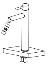
Retirez l'aérateur et laissez couler l'eau pendant environ 1 minute afin d'éliminer toutes les impuretés du robinet. Remettez l'aérateur en place.
