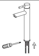
Fixez le gougon fileté en l'insérant dans le trou du corps du robinet en le serrant avec le tournevis.
