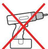
**Attention : pour éviter d'abîmer le pas de vis ou l'insert, procéder initialement en vissant la vis à la main avant d'utiliser la clé fournie en dotation**
